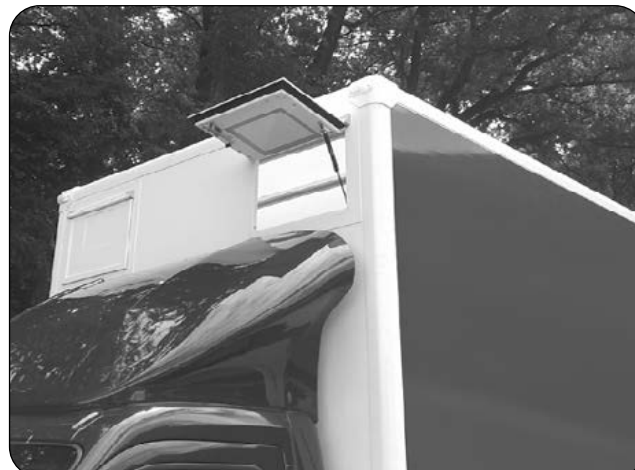
Malá izolovaná klapka s jednou vzpěrou Small insulated flap with one gas strut
