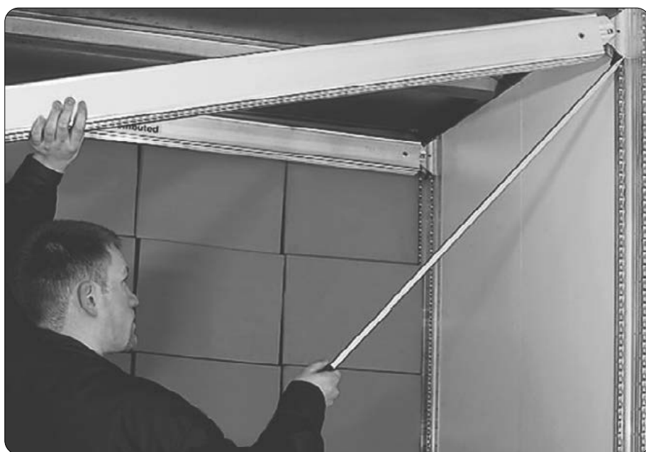
Nasazení nosníku ATD / Mounting pallet shoring bar ATD
