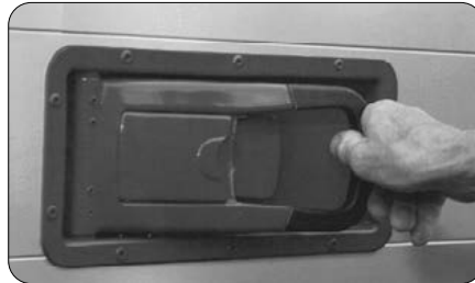
Nerezový zámek pro boční i centrální uzamykání bočnice
